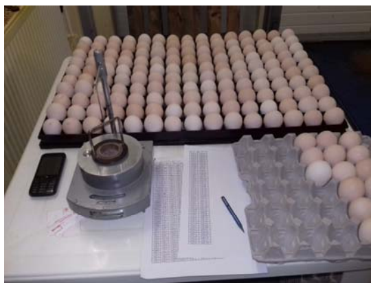
Рис.9 Прибор для измерения показателя плотности фракций белка ППФ-1
