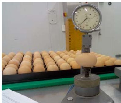
Рис.7 Прибор для измерения упругой деформации скорлупы яиц (ПУД-1)
