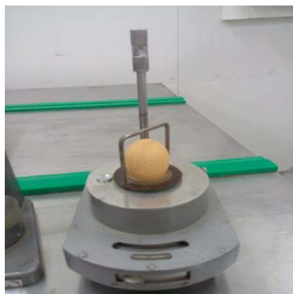
Рис.9 Прибор для измерения показателя плотности фракций белка ППФ-1
