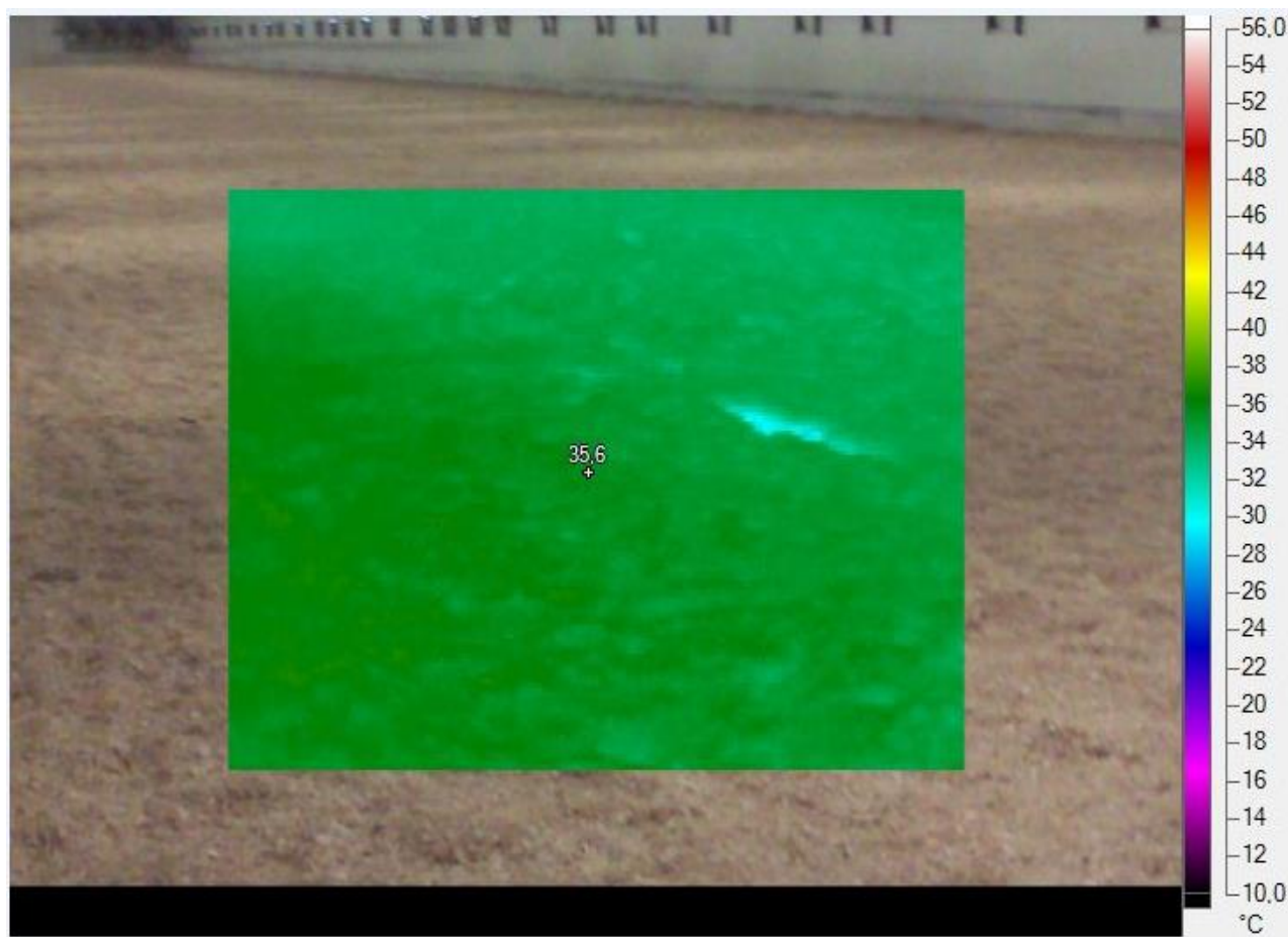
Рисунок 30 - Выровненное температурное поле под обогревателем
