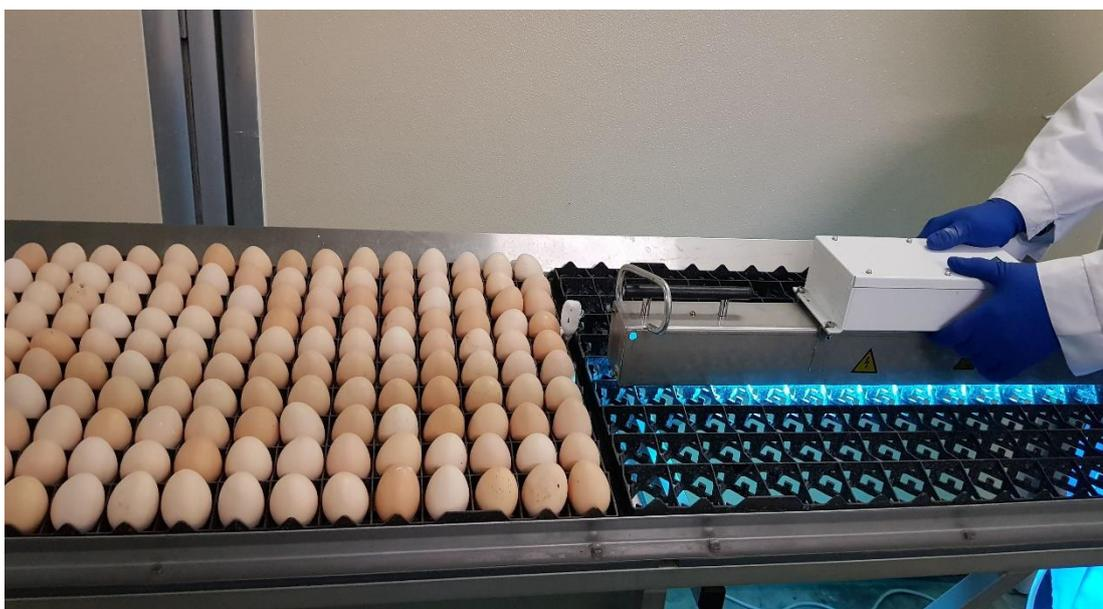
Рисунок 3 - Обработка инкубационных яиц на опытно-промышленной установке ООО «АГРОНИС» ОТЛ-М-Э
