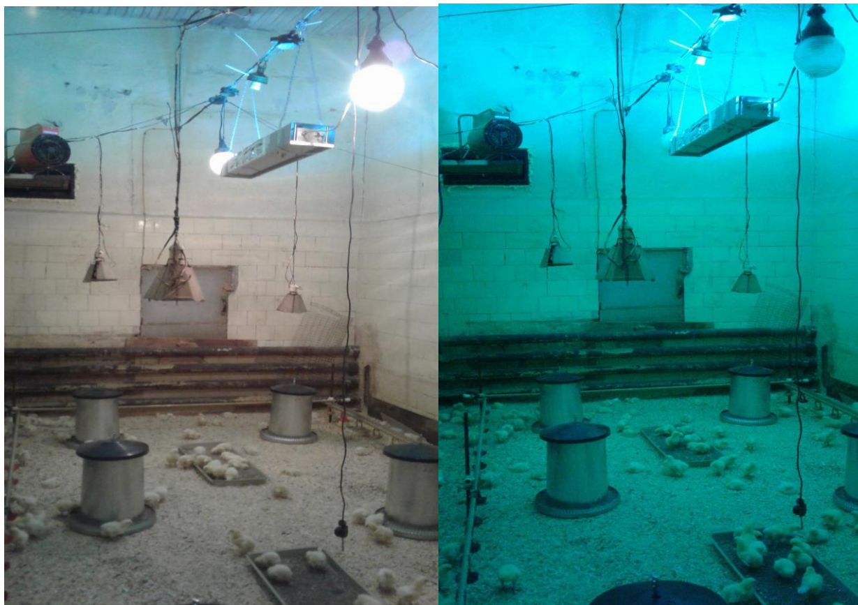
Рисунок 6 – УФ-облучение воздуха амальгамной лампой методом непрямого облучения в опытном боксе. Слева при включенном освещении, справа без освещения.
